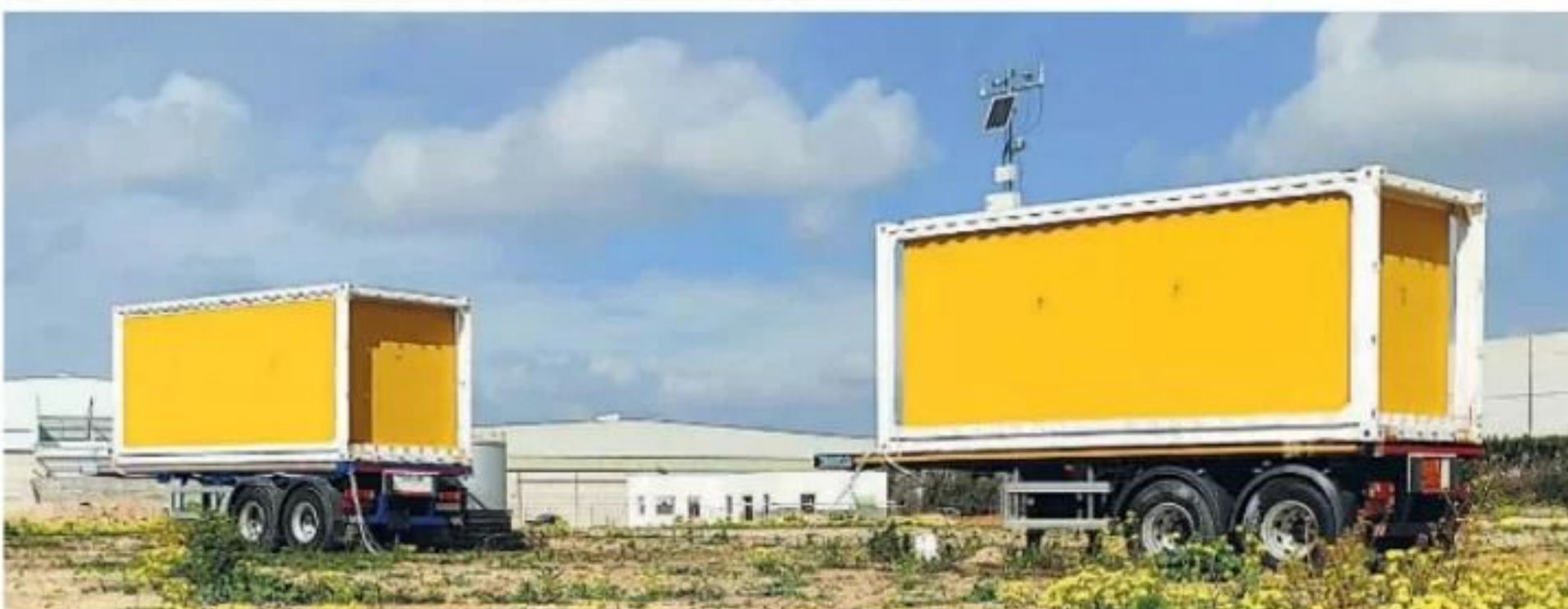
Ambas construcciones con igual transmitancia térmica U para así comparar la inercia térmica
