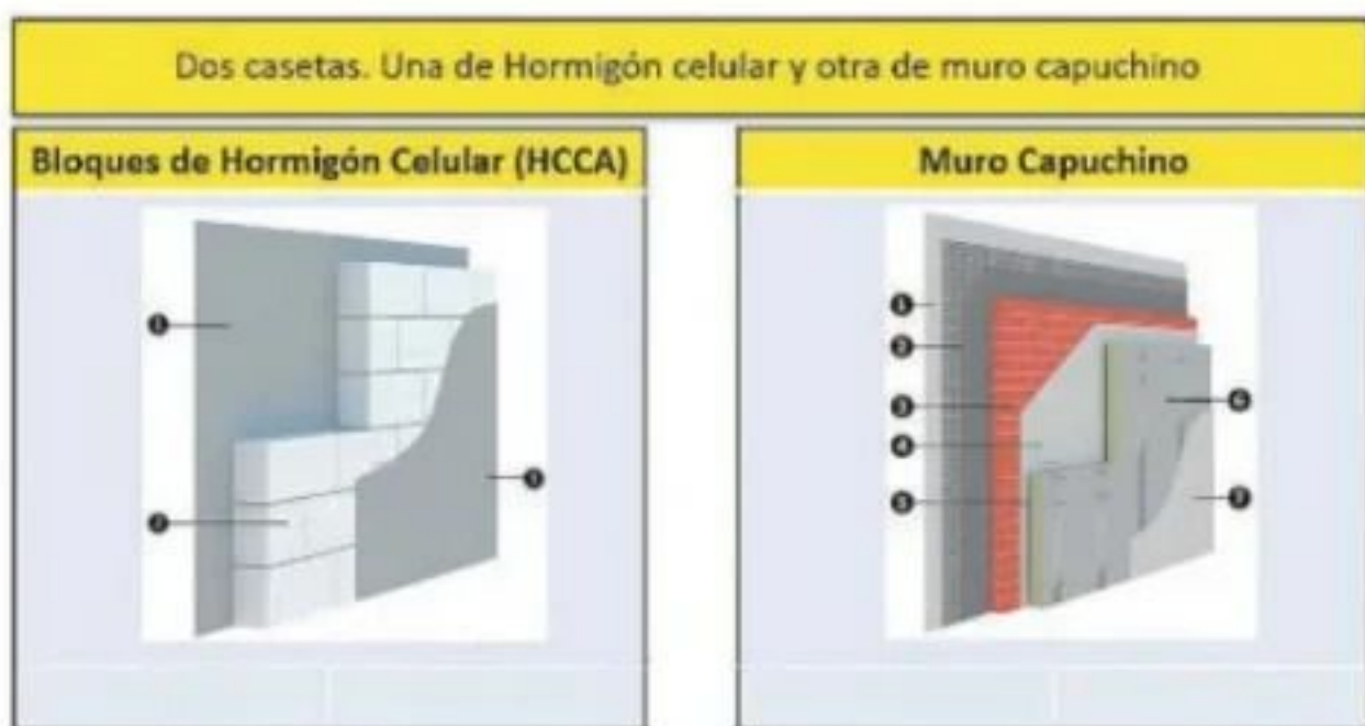
Ambas construcciones con igual transmitancia térmica U para así comparar la inercia térmica
